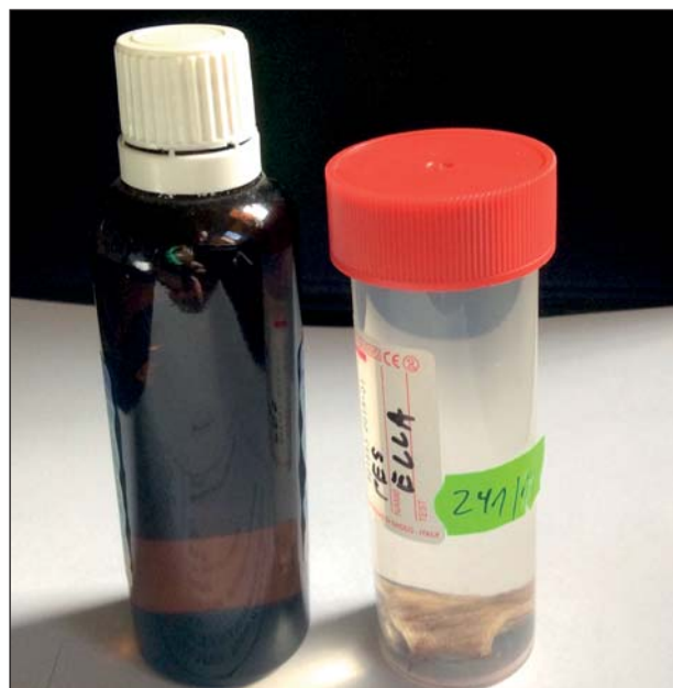
Obr. 4 – Nevhodná odběrová nádobka (bílé víčko) ze skla s úzkým hrdlem, chybí označení jménem zvířete/majitele. Vhodná nádobka (červené víčko) z plastu se širokým hrdlem a správným označením vzorku
